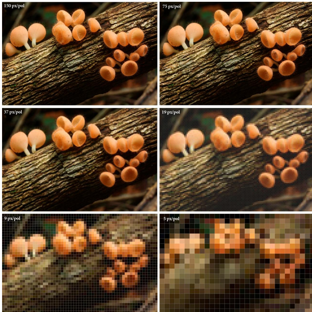
FIG. 1. A resolução tem um impacto direto na qualidade da imagem. Quanto maior a resolução, maior a densidade de pixels e de informação que a imagem contém. Por exemplo, a imagem com resolução de 150 px/pol tem 629.856 pixels, enquanto a imagem com 5 px/pol tem apenas 620 pixels. O tamanho do pixel variou nas diferentes resoluções para manter a mesma dimensão entre as imagens.
